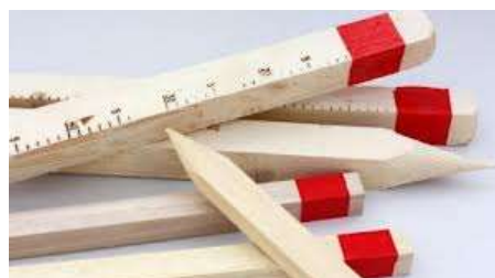
Fig. 9 - Picchetti in legno e picchetto in legno con chiodo
