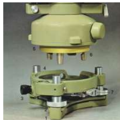
1) piastra di base, 2) vite calante, 3) piombino ottico, 4) coppa di centraggio, 5) flangia di centraggio, 6) piedini, 7) leva di bloccaggio
