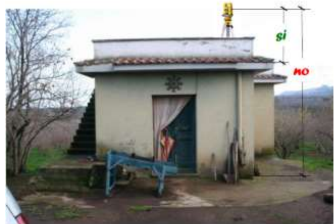
Fig. 17 – Errata determinazione dell'altezza strumentale
