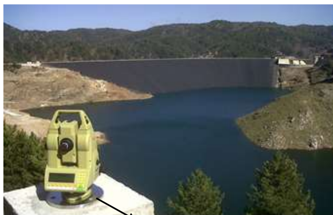
Piastra circolare di centramento fischerata su pilastro
